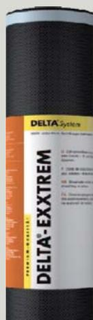
Hochreißfestes PES-Spezialvlies mit diffusionsoffener, wasserdichter Dispersions-Beschichtung und integrierten Klebezonen an beiden Rändern
